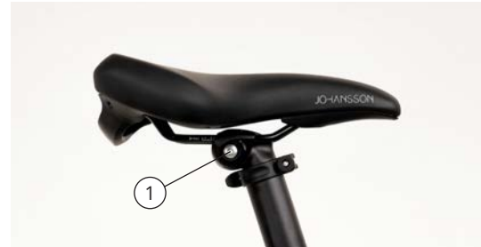
Einstellung der Sattelneigung
