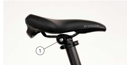
Einstellung der Sattelneigung
