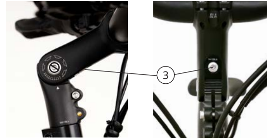
Einstellung des Lenkervorbaus
