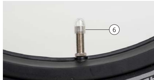
Am Ventil mit geeigneter Pumpe den Druck prüfen
